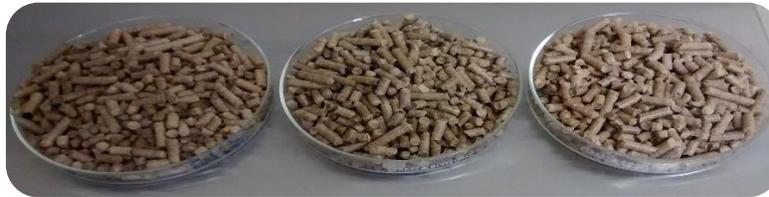
**Figura 1.** Pélets elaborados con aserrín a contenido de humedad de 7, 9 y 11% (izquierda a derecha).
