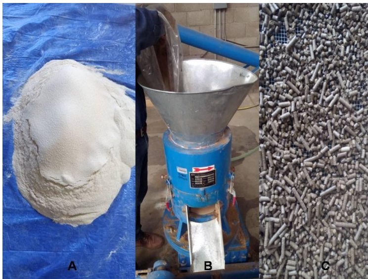
Figura 1. Proceso de elaboración de pelles. A. Acondicionamiento del material a temperatura ambiente. B. Proceso de pelletización. C. Pellets obtenidos.
