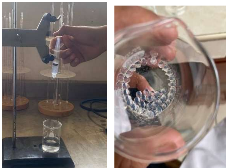
Figura I. Proceso de obtención de las esferas, 1a) Gelificación por goteo de las soluciones biopoliméricas y 1b) esferas gelificadas.
