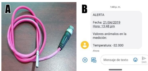
Figura 5. A=Sensor de temperatura (daño en conector), B=Captura de pantalla de un mensaje de alerta de anomalía tipo 3.
