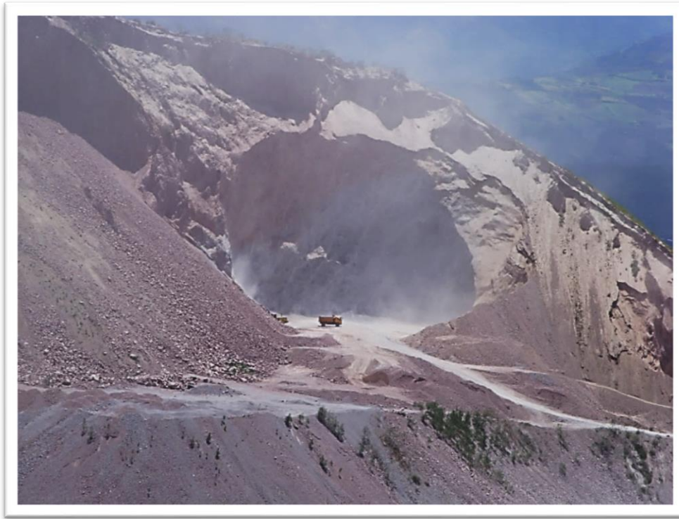
Figura 1. Talud inestable de más de 90° en una cantera en la Mitad del Mundo.
