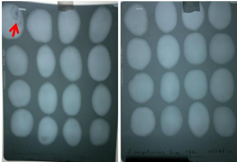
Figura 1. Prueba de viabilidad mediante Rayos-X en semillas de *Lysiloma acapulcense*. La flecha indica semilla dañada.
